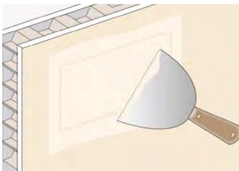
5 - En finition, appliquez un enduit pour plaques de plâtre.
