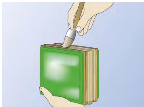
3 - Encollez la base et le côté de la première brique avec une colle à bois.
