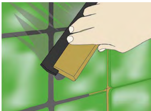
7 - Réalisez un mortier pour joints de la couleur désirée, puis appliquez-le à la raclette en caoutchouc.
