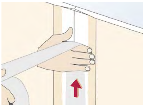
3 - Placez la bande sur l'axe du joint, du bas vers le haut.
